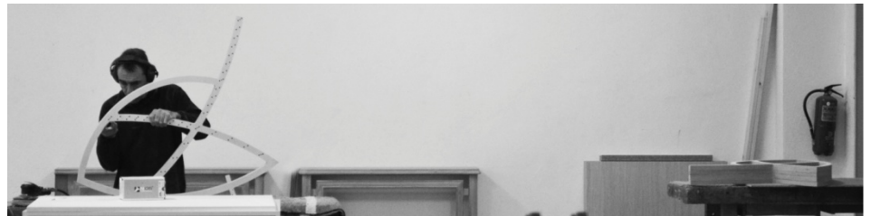
Polít manual dels cantells després d'obtenir la peça de la fresadora, taller de Joanetes (la Vall d'en Bas).
